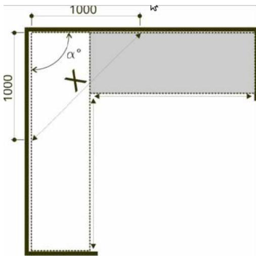
Рис.2. Если  $X$  больше 1414 мм, то угол не является прямым, он больше  $90^\circ$ . Длина помещения, измеренная по стене, будет меньше длины, измеренной на расстоянии 600 мм от стены на  $Y$ .
