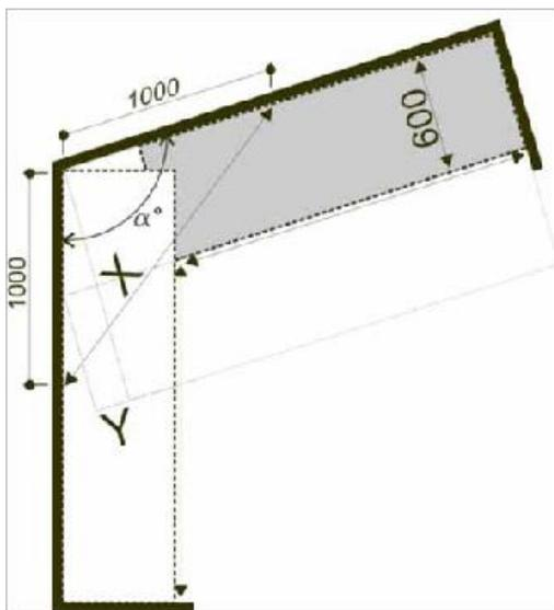
Рис.3. Если  $X$  меньше 1414 мм, то угол острый, меньше  $90^\circ$ . Длина помещения, измеренная по стене, будет больше длины, измеренной на расстоянии 600 мм от стены на  $Y$ .
