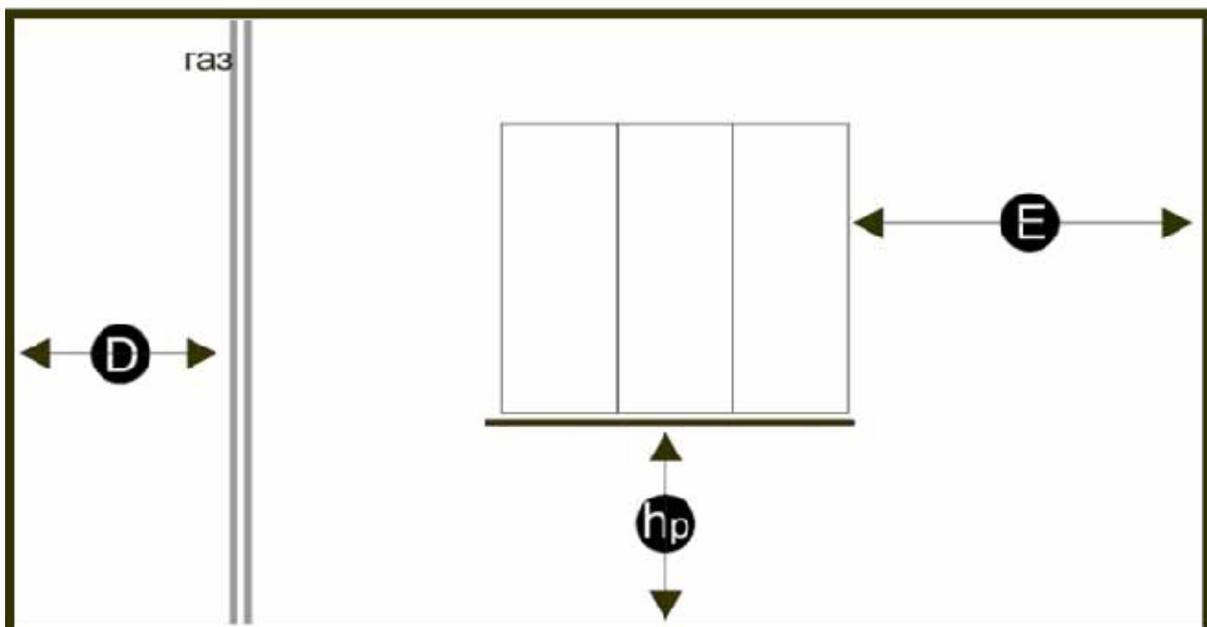
Основные из дополнительных размеров, которые могут понадобиться – это расстояние от ближайшего угла помещения до газовой трубы (D), расстояние от угла до окна (E), расстояние от пола до подоконника ( $h_p$ ), а также, насколько сантиметров подоконник выступает от стены внутрь кухни.
